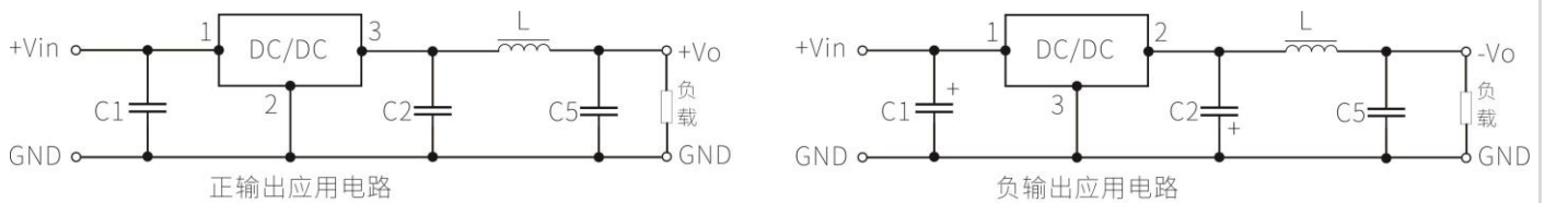
图3 'LC' 滤波应用电路
